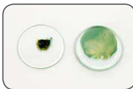
Vários aspectos na cor - contaminação da graxa
