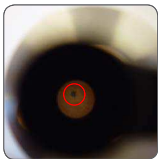
Partícula preta (devido à ex. oxidação, vedações, etc.)
