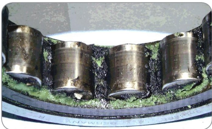
Degradação do lubrificante causada por descargas elétricas
